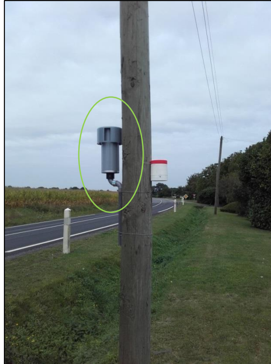
Figure 22 : Photographie du dispositif de prélèvement des poussières PM10
