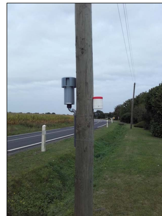
Figure 90 : Photographie du dispositif de prélèvement des poussières PM10 Source : BURGEAP
